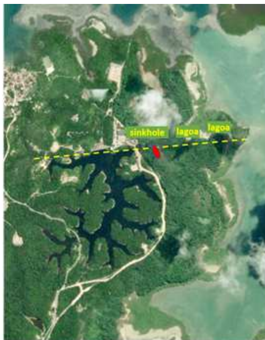
Figura 5 – Mostra o trend W-E formado entre o eixo da barragem, o sinkhole e duas lagoas próximas, situadas a leste do sinkhole.
